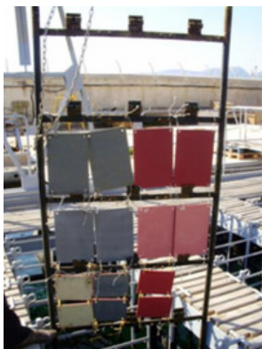
1- Plaques revêtues de peintures. Test en immersion en situ (Arsenal Mourillon à Toulon). Copyright Mer Paca
