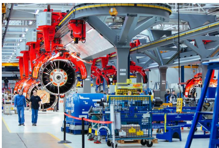
SAFRAN – Usine du futur – ligne d'assemblage pulsée dédiée à l'assemblage final du moteur LEAP ©C. Abad/Capa Pictures/Safran
