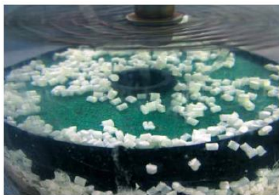
Process de séparation des particules de caoutchouc du plastique par Axion Polymers
